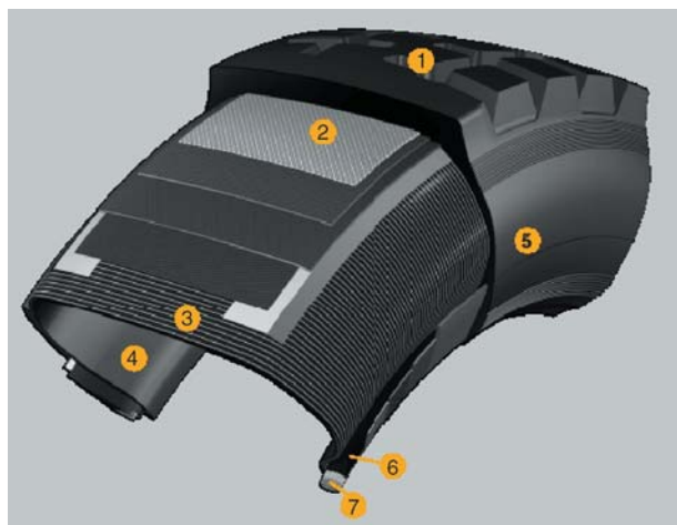
1. ábra. Radiális abroncs szerkezete
